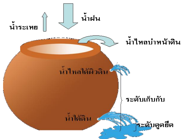
รูปที่ 7. ภาพจำลองพฤติกรรมของน้ำในชั้นดิน
